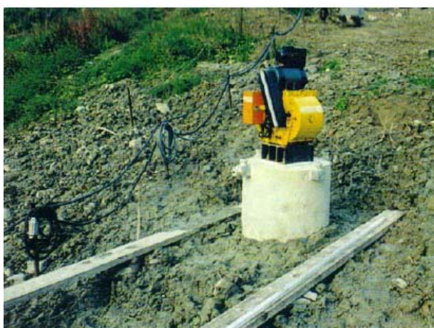
Fig. 8 – Prova dinamica a bassa frequenza con vibrodina meccanica
