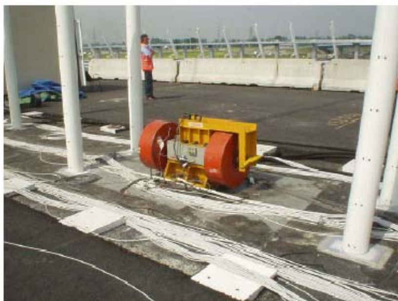
Studio vibrazionale ed esecuzione di prove di vibrazione con macchina idraulica posizionata in orizzontale
