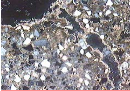
Luce trasmessa Nicol +; 70x al vero Visione generale della sezione.
